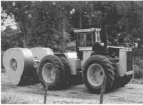
图1 冲击压实设备
