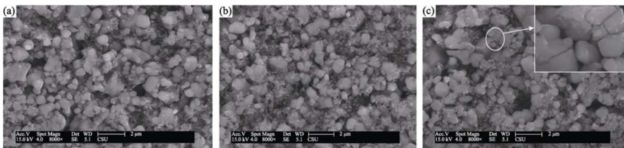
图9 LiFePO 4 /LTO 电池循环前后 LiFePO 4 极片的 SEM 照片
