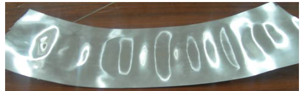
图7 轧制实验获得的L翘复合中浪浪形模式
