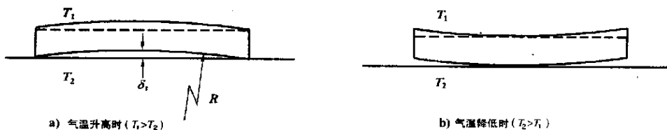
图1 砼路面板的温度翘曲变形
